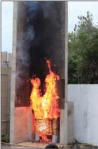
亚士保温系统大型火试验墙
